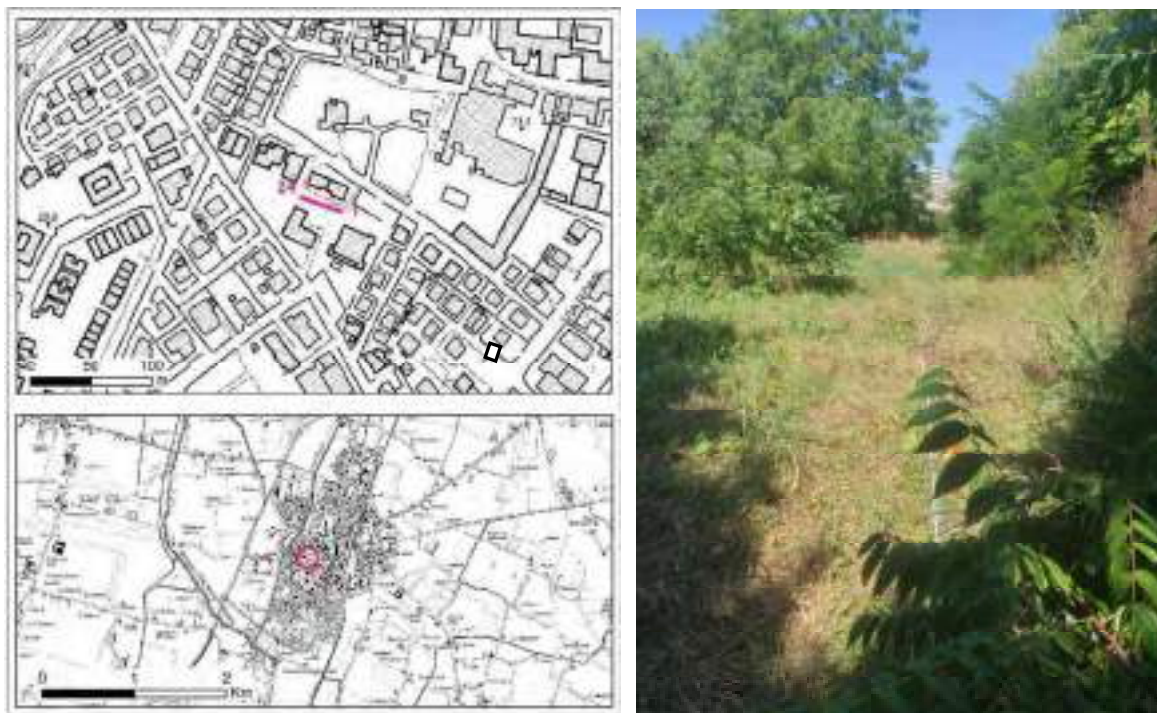
Figura 1. A sinistra: Estratto da CTR con ubicazione dello stendimento attivo MASW (con indicazione della posizione dei geofoni estremi 1 e 24) e inquadramento territoriale; a destra: stendimento sismico attivo MASW eseguito a Bagnolo in piano (RE), in via E. Curiel, il 17 luglio 2025.
